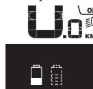
Ha az eBike-a két akku van behelyezve, és mindenkit a kerékpáron tölti, akkor a kijelző mindenkit akku töltésének előrehaladása megjelenik (az ábrán éppen a bal oldali akku töltése folyik). Az akku villogó jelzéséről megismerheti, hogy a két akkumulátor közül melyik akkumulátor töltése folyik éppen.
