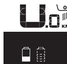
Kui kahe paigaldatud akuga eBike'il laetakse mõlemat akut jalgrattal, siis kuvatakse ekraanil mõlemaaku laadimise edenemist (joonisel laetakse parajasti vasakpoolset akut). Millist kahest akust hetkel laetakse, saatte näha ka akul vilkvast näidust.
