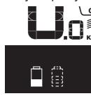
Če se na električnem kolesu z dvema akumulatorskima baterijama polnila obe akumulatorski bateriji, je na prikazovalniku naveden napredek polnjenja obeh akumulatorskih baterij (na sliki se polni leva akumulatorska baterija). Po utripajočem prikazu na akumulatorski bateriji lahko vidite, katera od obeh akumulatorskih baterij se trenutno polni.
