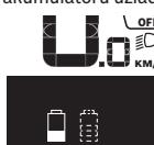
Ja vienā elektrovelosipēdā ir ievietoti divi akumulatori un abi šie akumulatori tiek uzlādēti tieši uz velosipēdu, uz displeja tiek parādīta abu akumulatoru uzlādes gaita (attēlā tiek parādīta kreisā akumulatora tiešā uzlāde). To, kurš no abiem akumulatoriem tieši tiek uzlādēts, parāda mirgojōs indikators uz attiecīgā akumulatora.
